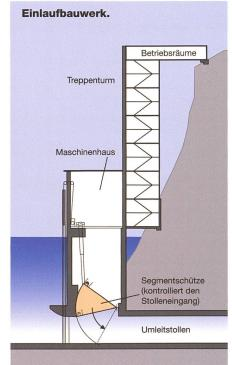
Bild 2. Querschnitt des Einlaufbauwerks zum Umleitstollen (EWZ).
