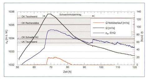
Bild 11. Wasserspiegellage  $z_W(t)$  45 m vor Rechen und Abfluss Q(t) über Notüberlauf beim EHQ mit Schwemmholz.
