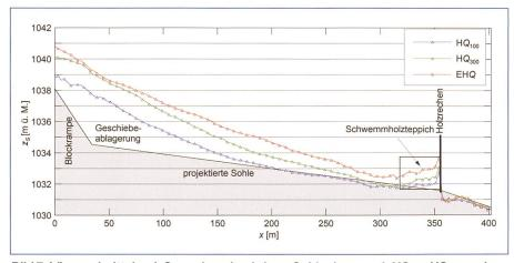
Bild 7. Längsschnitt durch Sammler mit mittlerer Sohlenlage nach  $HQ_{100}$ ,  $HQ_{300}$  und EHQ mit Schwemmholz.
