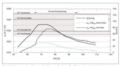
Bild 10. Wasserspiegellage  $z_W(t)$  45 m vor Rechen für  $HQ_{300}$  mit und ohne Schwemmholz. Dargestellt sind zusätzlich die Höhenlagen des Rechens, der Tauchwand sowie der Notüberlaufschwelle.
