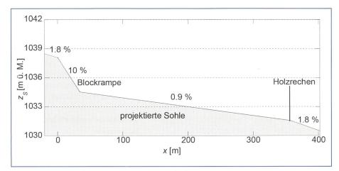
Bild 2. Projektierte Sohlenlage z<sub>s</sub> im Längsschnitt.
