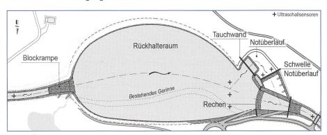
Bild 1. Übersicht des hydraulischen Modells an der VAW, Modellmassstab 1:30.
