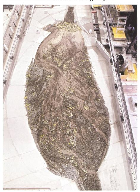
Bild 9. Schwemmholz- und Geschiebeablagerungen für optimierte Sammlerform nach  $HQ_{300}$ .
