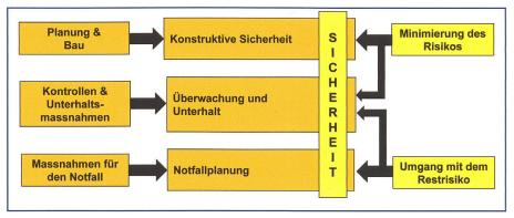
Bild 2. Das Sicherheitskonzept der Sektion Talsperren basiert auf drei Bereichen. (Quelle: G. Darbre)
