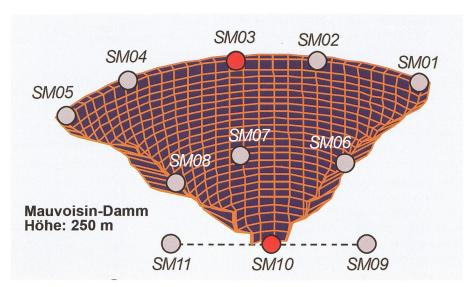
Bild 4. Erdbeben-Messung am Staudamm. (Quelle: BFE)
