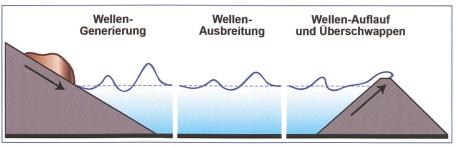
Bild 5. Impulswellen-Entwicklung in drei Phasen. (Quelle: VAW)
