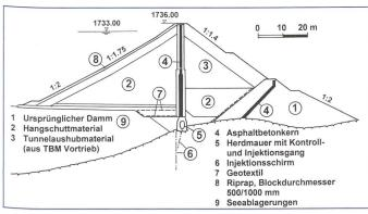
Bild 14. Rotgüldensee-Damm, Österreich: Erhöhter Dammteil auf der Oberwasserseite des bestehenden Dammes gebaut, mit Asphaltbetonkern (Neururer et al., 1991).
