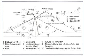
Bild 11. Hengshan-Damm, China: (a) Erhöhung durch Steinschüttdamm mit Betonoberflächendichtung. Sockel sitzt auf der Krone eines Kiesschüttdammes mit schmalem Kern, (b) Verbindung Sockel mit Dichtwand (Li, Li, 2009).
