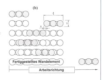
Bild 10. MIP-Verfahren: (a) Grossbohrgerät mit Dreifach-Bohrschnecke, (b) Bauvorgang mit überlappenden prismatischen Erdbetonelementen (Wildner et al., 2002).
