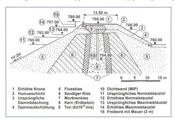
Bild 8. Sylvenstein-Damm: Querschnitt mit Erhöhungsmassnahmen (Wildner et al., 2002).
