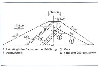
Bild 1. Querschnitt durch den obern Teil des Golpayegan-Dammes, Iran.
