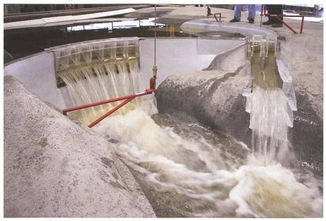
Figure 7. Cambambe, essais sur modèle hydraulique physique, 2010-2012.
