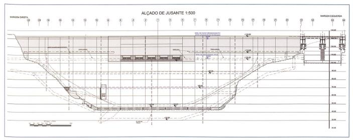
Figure 3. Projet de surélévation du barrage de Cambambe, vue développée en direction de l'amont.
