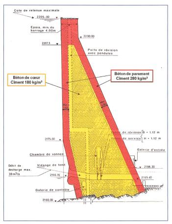
Figure 6. Zonage du béton, coupe-type du barrage.
