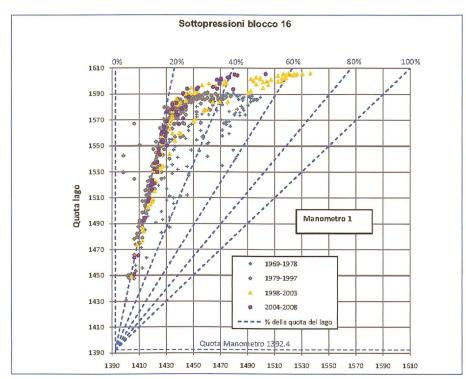
Fig. 6. Sottopressioni misurate sotto il Blocco 16.
