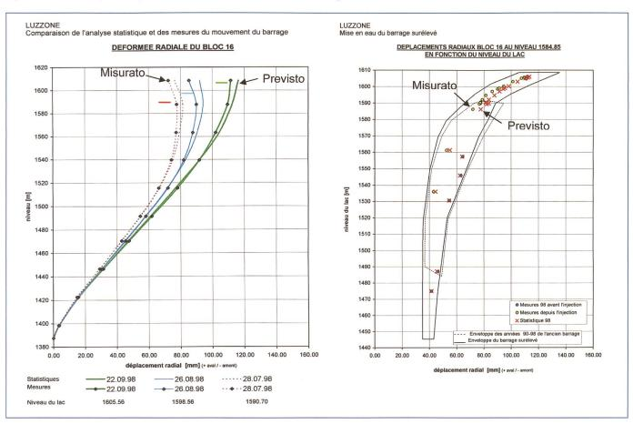
Fig. 5. Previsione e misura degli spostamenti del blocco centrale (Blocco 16).
