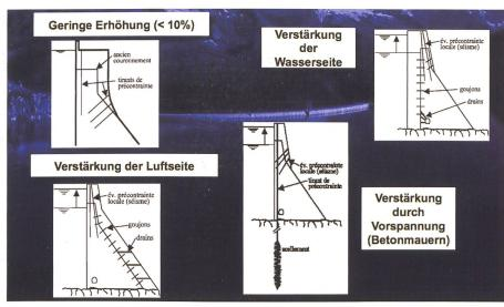
Bild 4. Grundsätzliche Möglichkeiten für die Erhöhung von Talsperren am Beispiel von Gewichtsmauern (schematisch).
