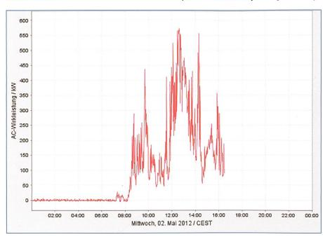
Bild 7. Variabilität Windproduktion am Mont Soleil (CH), Produktion 2.5.2012.
