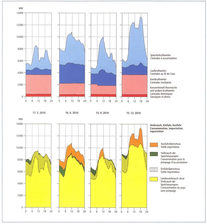
Bild 5. Anteile Leistungsabruf der Kraftwerke und Verbrauch sowie Einfuhr/Ausfuhr nach Jahreszeit (Quelle: Schweiz. Elektrizitätsstatistik 2010, BFE 2011).
