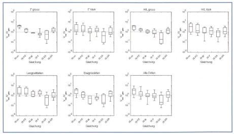
Bild 5. Verhältnis berechneter zu gemessener Geschiebefracht ( $V_{\rm ber}/V_{\rm gem}$ ) für verschiedene Gleichungskombinationen (s. Tabelle 2), differenziert nach verschiedenen Datentypen (s. Tabelle 3). Die gestrichelte Line beim Wert 1 entspricht einer perfekten Übereinstimmung von Berechnung und Beobachtung (verändert nach Nitsche et al., 2011).
