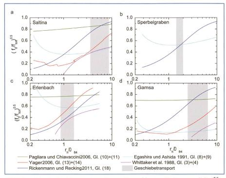
Bild 3. Anteil des Basiswiderstands am Gesamtfliesswiderstand in Form von  $(f_0/f_{to})^{0.5}$  bei unterschiedlichen relativen Abflusstiefen  $(r_h/D_{84})$  für die vier unterschiedlich rauen Gerinne in Bild 2. Jede Farblinie zeigt die Berechnungen für einen Fliesswiderstandsansatz (vgl. Tabelle 2). Die grauen Flächen geben den Bereich an, in dem 90% des Geschiebetransports während der untersuchten Ereignisse auftrat (verändert nach Nitsche et al., 2011).
