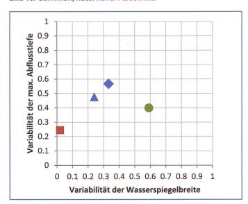
Bild 14. Variabilität der maximalen Abflusstiefe bzw. der Wasserspielgelbreite in den revitalisierten Abschnitten (blau) im Vergleich zu einem kanalisierten Abschnitt (rot) und einem naturnahen Referenzzustand (grün). Werte standardisiert nach Woolsey et al. (2005).
