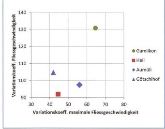
Bild 15. Variationskoeffizient aller Fliessgeschwindigkeitsmessungen (Y-Achse) aufgetragen gegen den Variationskoeffizienten der maximalen Fliessgeschwindigkeiten (X-Achse). Werte sind nicht standardisiert.
