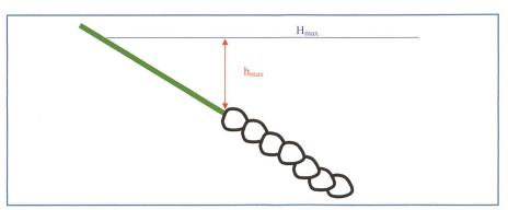
Bild 4. Definition der maximal zulässigen Abflusstiefe über einer Grasböschung an einem Flussufer (nach ASF, 1973).
