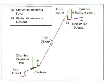
Figure 8. Schéma du puits blindé de l'aménagement de pompage-turbinage de Grimsel II. Les deux stations de mesures S1 (à l'entrée de la centrale) et S2 (entre le puits incliné et la chambre d'équilibre verticale) sont encore indiquées.
