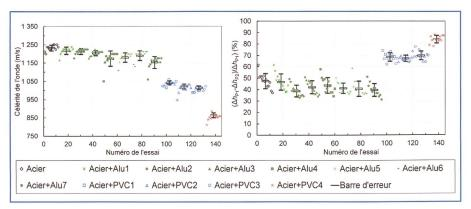
Figure 6. A gauche, les célérités de coup de bélier et, à droite, les atténuations de leur amplitude à l'intérieur de la conduite d'essai entre les points de mesures S1 et S2 pour les 12 configurations testées.
