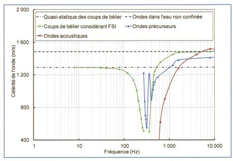
Figure 2. Célérités des ondes des coups de bélier dans les puits et galeries blindés dans le cas quasi-statique et en considérant le FSI. Les ondes précurseur et acoustiques sont également présentées.
