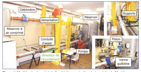
Figure 4. Modèle physique à échelle réduite construit au Laboratoire de Machines Hydrauliques (LMH) de l'Ecole Polytechnique Fédérale de Lausanne (EPFL).
