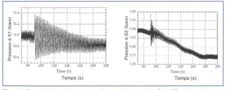
Figure 9. Pressions dynamiques mesurées aux deux stations S1 et S2 sur le puits blindé de Grimsel II durant l'arrêt d'une turbine.
