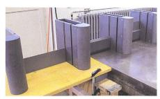
Bild 3. Fertigung der Wehranlage aus PVC (Foto: VAW-ETHZ).
