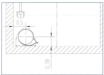
Bild 3. Kostenoptimierte Entsanderform mit minimalem Aushubvolumen.
