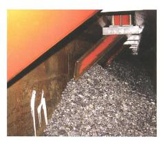
Bild 6. Typischer Füllgrad von Spülrohr oder Spülkanal.
