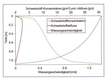
Bild 2. Schematische Vertikale Verteilung der Fliessgeschwindigkeit, der Schwebstoffkonzentration und des Schwebstoffabflusses.
