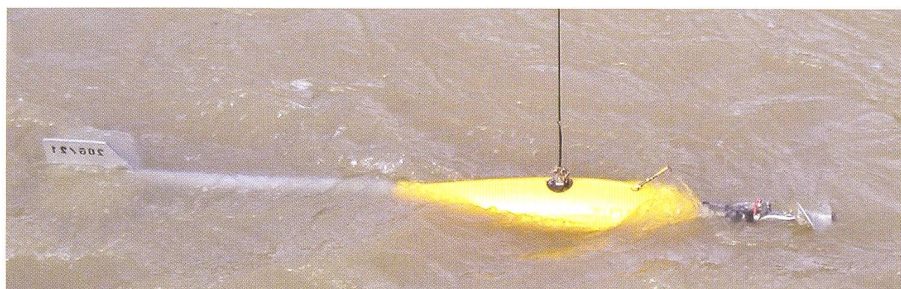
Bild 6. Hydrometrischer Flügel zur Messung der Fliessgeschwindigkeit.
