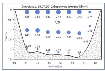
Bild 7. Profil der Schwebstoffkonzentration (a, links oben) und der Fliessgeschwindigkeit (b, rechts oben) in der hydrometrischen Station Rhein-Diepoldsau.
