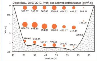
Bild 9. Profil des Schwebstoffabflusses. Dieser ergibt sich an jeder Messstelle aus dem Produkt der Schwebstoffkonzentration und der Fliessgeschwindigkeit des Wassers.
