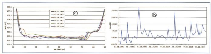
Bild 4. Querprofile (a) und Ganglinie der mittleren Tiefe (b) der Gewässersohle des Rheins bei Diepoldsau.
