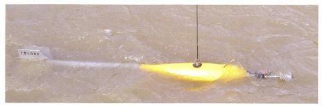
Bild 6. Hydrometrischer Flügel zur Messung der Fliessgeschwindigkeit.
