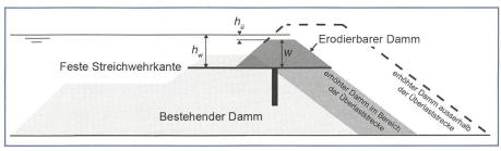
Bild 1. Querschnitt der sanierten Dammstrecke am Hagneckkanal und Definition der Dammhöhe w, der Überfallhöhe  $h_{\ddot{u}}$  und des Wasserstands  $h_{w}$ .
