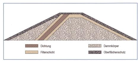
Bild 2. Genereller Querschnitt eines erodierbaren Damms.
