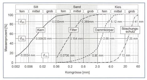
Bild 5. Kornverteilungskurven der für den Prototyp vorgesehenen Materialien.
