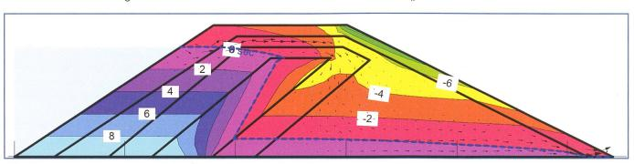
Bild 6. Porenwasserspannungen [kN/m²] beim Damm mit Dichtungskern im stationären Zustand mit  $h_w = 1.0 \text{ m}$ .
