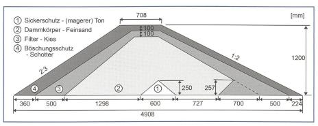
Bild 9. Geometrie und Dammaufbau des erodierbaren Damms aus Feinsand.
