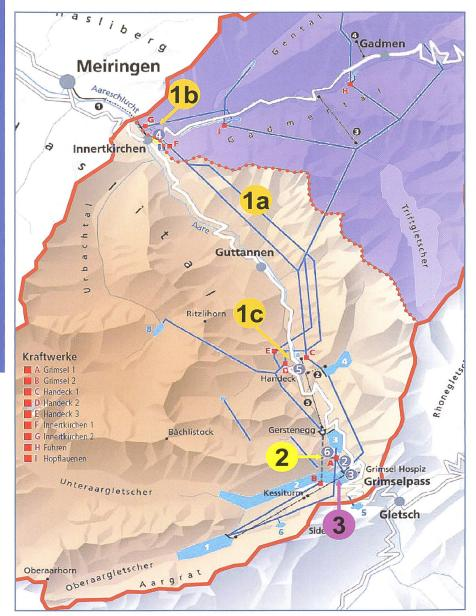
Bild 1a. Das Einzugsgebiet der KWO und die Ausbauvorhaben KWO plus: 1a = Tandem mit Parallelschacht zur Minderung der Reibung, 1b = Tandem mit Aufwertung Kraftwerk Innertkirchen 1, 1c = Tandem mit Aufwertung Kraftwerk Handeck 2, 2 = Neubau Pumpspeicherwerk Grimsel 3, 3 = Vergrösserung Grimselsee. Zusätzlich sind noch die hydrologischen Einzugsgebiete des Aaretals (Grimsel) in orange und des Gadmertals (Susten) in lila eingezeichnet.
