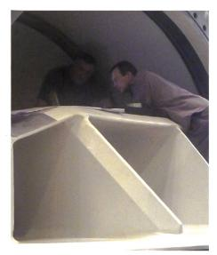
Figure 8. Vanne papillon DN 3000 de la prise d'eau Nord lors de la réception en hiver 2009–2010.
