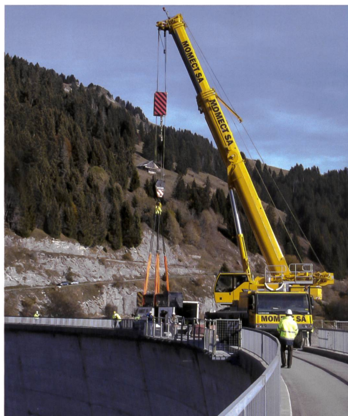
Figure 7. 29 octobre 2009: Essai de levage à 28 t sur le couronnement Nord, qui confirmait les concepts théoriques in situ.
