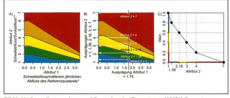
Bild 8. Umformulierung einer zweidimensionalen Bewertung. A) MSK-Bewertung von Schwall-Sunk, B) Ablesen der Werte, C) Wertfunktion bei einem Wert von 1.75 für Attribut 1. \*korrigiert für die Einzugsgebietsfläche, \*\*korrigiert für die Pegeländerungsrate.
