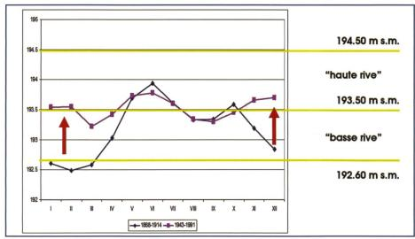
Figure 3. Niveaux moyens mensuels du lac Majeur (périodes avant et après la construction du Barrage de la Miorina à Sesto Calende – source des données: www. hydrodaten.admin.ch/i/2022.htm); à coté est signalé les limites des berges trouvé en 1922 par Jäggli. Les flèches rouges signalent le changement vers des niveaux moyens plus hauts, qui éliminent presque la «basse rive» littorale.
