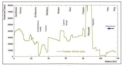
Bild 3. Transportdiagramm des aktuellen Geschiebehaushalts der Rhone.
