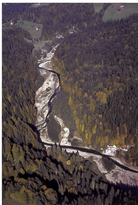
Bild 7. Schwarzwasser im Kanton Bern. Steilerer oberer Abschnitt a), flacherer unterer Abschnitt b). Die Regimebreite resp. vegetationsfreie Breite nimmt mit dem Gefälle ab (Aufnahmen J.Cl. Bersier, Freiburg).
