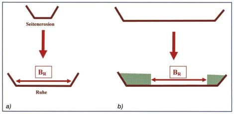
Bild 6. Schematische Darstellung der Gerinnebildung von einem engen Richtkanal aus (a), durch sukzessive Verengung durch Aufkommen der Vegetation (b).
