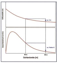
Bild 10. Einfluss einer Verbreiterung von der heutigen Breite auf die Regimebreite auf die Wasserspiegel und den Geschiebetransport.
