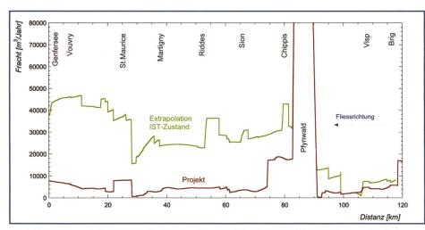
Bild 11. Transportdiagramm der Rhone für den IST-Zustand (Extrapolation des heutigen Zustandes ohne Massnahmen) sowie nach der 3. Rhonekorrektion gemäss generellem Projekt (Stand 2008).
