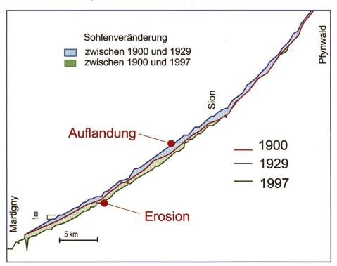
Bild 2. Entwicklung des Sohlenlängenprofils der Rhone seit der 1. Korrektion.
