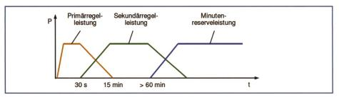
Bild 13. Drei verschiedene Regelleistungsarten zur Sicherstellung Netzstabilität.
