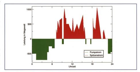
Bild 14. Typischer Tagesgang eines Pumpspeicherwerkes mit Pumpbetrieb in der Nacht und Turbinenbetrieb am Tag.
