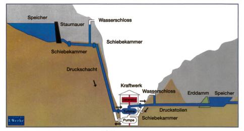
Bild 11. Illustration Funktionsweise PSW.
