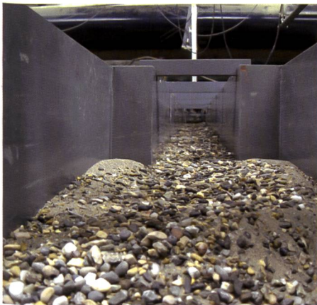
Bild 2. Modellversuch im hydraulischen Labor LCH an der ETH Lausanne ohne die Schwelle: Blick vom Hauptfluss in den aufgeweiteten Einmündungsbe-reich des Seitenflusses. Durch die Auf-weitung der Einmündung entsteht eine abwechslungsreiche Sohlenmorpho-logie. Diese ist Voraussetzung für neue Lebensräume und die Durchgängigkeit (Foto EPFL/LCH).
