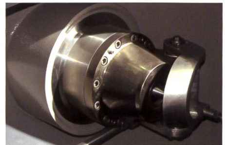
Bild 29. Innenregulierte Düse mit Strahl- ablenker.
