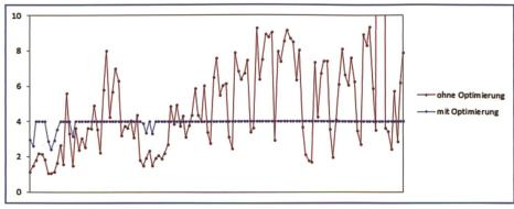
Bild 2. Schwall/Sunk-Verhältnis mit und ohne Optimierung.
