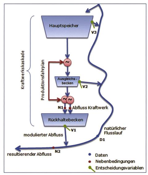
Bild 1. Schema optimales Abflussregime.
