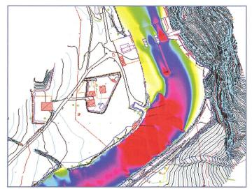
Figure 5. Vitesses d'écoulement au droit du barrage pour un débit de 1270 m³/s dans la géométrie «après purge» (couleur jaune: 1 m/s, couleur rouge: 6 m/s).
