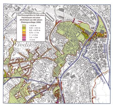
Bild 2. Überflutungskarte der Zürcher Innenstadt im Falle eines Hochwassers der Sihl mit einer Wiederkehrperiode von 300 Jahren (ca. 450 m³ s⁻¹). Die verschiedenfarbigen Flächen geben die Höhe einer Überschwemmung im Stadtgebiet an (HB = Hauptbahnhof). Die vollständige Originalkarte ist online verfügbar unter: www.gis.zh.ch [Juli 2010].
