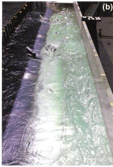
Bild 9. Strömungsmuster in der Sammelrinne für (a) EHQ mit Tauchstrahl und (b) Überlastfall mit Oberflächenstrahl. Blick in Fliessrichtung.
