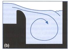
Bild 8. Abflussregimes in der Sammelrinne, (a) Tauchstrahl und (b) Oberflächenstrahl.
