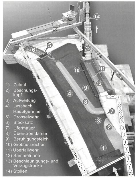
Bild 2. Physikalisches Modell der VAW im Massstab 1:16.
