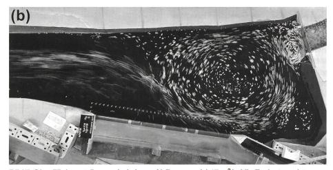
Bild 7. Oberflächenströmung bei einem Abfluss von (a) 17  $m^3$ /s (die Entlastung ist gerade nicht in Betrieb) und (b)  $HQ_{100}$  mit offener Drossel (5  $m^3$ /s), beide für den Ausführungsvorschlag.
