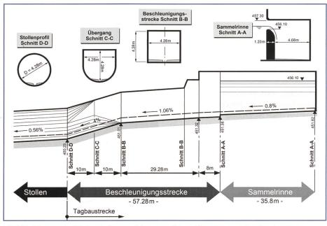
Bild 11. Längsschnitt durch Sammelrinne und Beschleunigungsstrecke des Ausführungsvorschlags, Fliessrichtung von rechts nach links.
