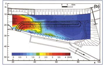
Bild 5. Horizontales Geschwindigkeitsfeld im Lyssbach und Beruhigungsteich bei EHQ mit geschlossenem Drosselwehr, (a) Ausgangsentwurf und (b) Ausführungsvorschlag.
