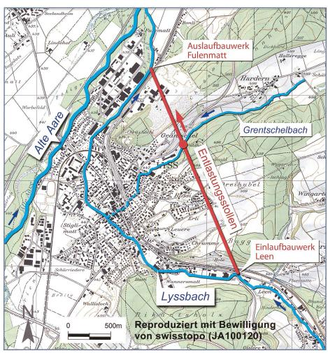
Bild 1. Projektgebiet mit dem geplanten Entlastungsstollen.
