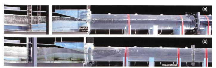
Bild 12. Abflussbild beim Übergang von Beschleunigungsstrecke zum Stollen im Ausführungsvorschlag bei (a) EHQ und (b) Überlastfall. In (b) schlägt die stehende Welle an, die Luftzirkulation ist lokal unterbrochen. Fliessrichtung von links nach rechts.
