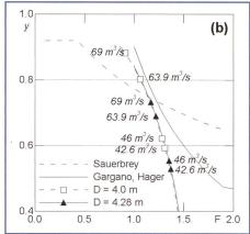
Bild 13. (a) Teilfüllungsverhältnis y[Q] und Froudezahl F[Q] für D=4.00 m und 4.28 m, und (b) effektive und maximal erlaubte Teilfüllungsverhältnisse nach Sauerbrey (1969) sowie Gargano und Hager (2002).
