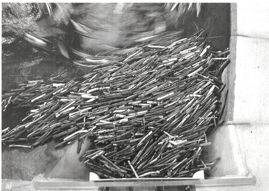
Bild 4. Von der Sohle bis über den Wasserspiegel verlegter Grobholzrechen (LF 2, nach Zugabe von 150 \text{ m}^3 Festholz), von der Rückseite betrachtet und nahe der unteren Rechenstirnseite.
