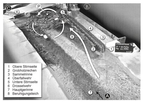
Bild 1. Einlaufbauwerk zum Entlastungsstollen bei Hochwasser mit Schwemmholzaufkommen, charakteristischer Schwemmholzpfad und Zirkulationszone. (A) Zufluss Lyssbach, (B) Abfluss im Entlastungsstollen, (C) Drosselwehrabfluss nach Lyss und (P) Wasserspiegel-Messpunkt.
