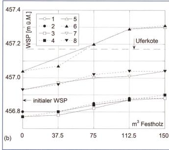
Bild 2. (a) Residualer Drosselwehrabfluss mit und ohne Drosselrechen (DR) und (b) Wasserspiegellagen im Beruhigungsteich bei P (Bild 1). Beide als Funktion der Schwemmholzzugabe und für LF gemäss Legende und Tabelle 1.
