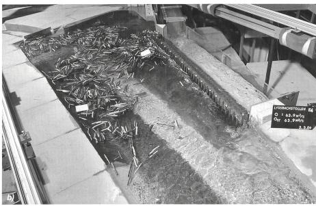
Bild 3. Schwemmholzsituation im Beruhigungsteich nach Zugabe von (a) 75 und (b) 150 m<sup>3</sup> Schwemmholz für LF 5.
