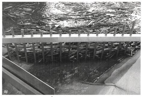
Bild 5. Nach Zugabe von 150 m³ Festholz beim LF 8, (a) verklaustes Drosselwehr ohne und (b) freies Drosselwehr mit Drosselrechen.
