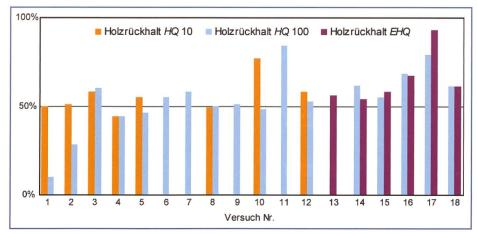
Bild 7. Rückhaltebilanz der durchgeführten Versuche mit Schwemmholzzugabe.
