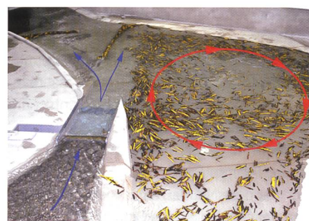
Bild 9. Situation nach einem EHQ mit der gewählten Bestvariante: angedeutet sind die «Hauptströmungsrichtungen» und die Rezirkulationszone im Holzrückhaltebereich.
