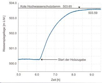
Bild 8. Auftürmen des Schwemmholzes am V-förmigen Holzrechen während eines HQ<sub>100</sub>-Ereignisses. Links: Während des Versuchs Nr. 5 (Blick gegen die Strömungsrichtung); rechts: Messung der Wasserspiegellage vor dem Holzrechen während des Versuchs Nr. 9.
