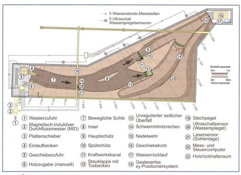
Bild 6. Übersicht des physikalischen Modells an der VAW auf Grundlage der vom Ingenieurbüro Maggia AG ausgearbeiteten Pläne, Modellmassstab 1:50.
