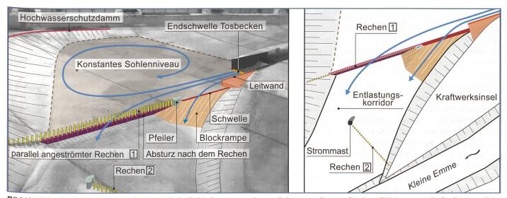
Bild 10. Links: Darstellung des optimierten Holzrückhalteraums mit parallel angeströmtem Rechen (Blick gegen die Strömungsrichtung). Rechts: Detail des optimierten Unterwasserbereichs mit einem zweiten Rechen.
