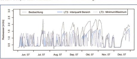
Bild 8. Angekettete COSMO-LEPS-Vorhersage (Tagesmittel) mit unterschiedlicher 3-Tage-Vorlaufzeit (TP) für die Periode Juni bis Dezember 2007. Die Graphiken beziehen sich auf die Vorhersage der Restwassermengen, welche aus dem Stausee in die Sihl (Bild 1) zur Einhaltung der Dotiermengen in Blattwag geleitet werden müssen.
