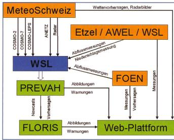
Bild 3. Schematische Darstellung der Vorhersagekette. Die orangen Felder kennzeichnen die Datenlieferanten (Dateninput); an der WSL laufen alle Daten zusammen und werden durch die Modelle PREVAH und FLORIS verarbeitet. Schliesslich werden Bilder und Auswertungen auf einer passwortgeschützten Web-Plattform veröffentlicht (siehe Badoux et al., 2010).
