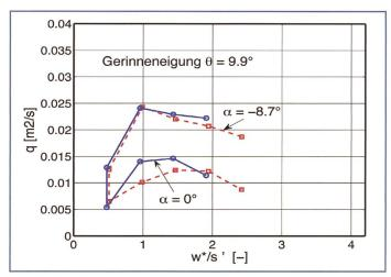
Bild 7. Grenzbereich der Abflussinstabilitäten auf horizontalen (Stufenneigung  $\alpha = 0^{\circ}$ ) und rückwärts geneigten ( $\alpha = -8.7^{\circ}$ ) eingetieften Stufen bei einer Gerinneneigung von  $\theta = 9.9^{\circ}$ .
