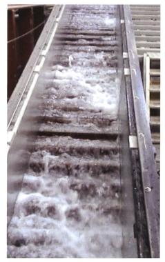
Bild 1. Abflussinstabilitäten (Jump Waves) auf einem Treppengerinne mit Neigung von  $\theta$  = 13.6° und einer Stufenneigung von  $\alpha$  = -5.0°, einer Schwellenhöhe von w = 60 mm bei einem Abfluss von q = 0.018 m²/s (LCH Versuch; Foto Ch. Knellwolf).
