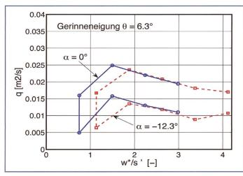
Bild 6. Grenzbereich der Abflussinstabilitäten auf horizontalen (Stufenneigung  $\alpha = 0^{\circ}$ ) und rückwärts geneigten ( $\alpha = -12.3^{\circ}$ ) eingetieften Stufen bei einer Gerinneneigung von  $\theta = 6.3^{\circ}$ .
