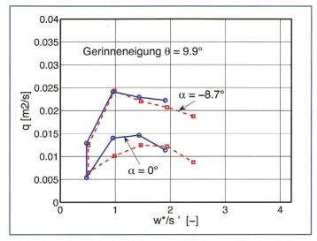
Bild 7. Grenzbereich der Abflussinstabilitäten auf horizontalen (Stufenneigung  $\alpha = 0^{\circ}$ ) und rückwärts geneigten ( $\alpha = -8.7^{\circ}$ ) eingetieften Stufen bei einer Gerinneneigung von  $\theta = 9.9^{\circ}$ .
