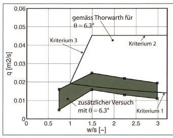
Bild 3. Auftretensbereich der Jump Waves gemäss Thorwarth (2008) für Gefälle zwischen 8.9° und 14.6° im Vergleich zu den zusätzlichen Versuchen für  $\theta$  = 6.3°.
