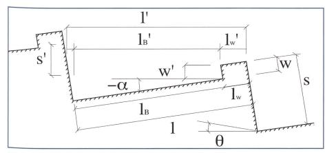
Bild 5. Definition der Geometrie von Stufen mit Gegenneigung und Endschwelle.
