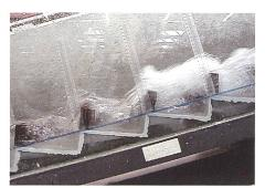
Bild 2. Abflussinstabilitäten (Jump Waves) auf einem Treppengerinne mit Neigung von  $\theta$  = 13.6° und einer Stufenneigung von  $\alpha$  = -5.0°, einer Schwellenhöhe von w = 60 mm bei einem Abfluss von q = 0.018  $m^2$ /s (LCH Versuch; Foto Ch. Knellwolf).
