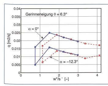
Bild 6. Grenzbereich der Abflussinstabilitäten auf horizontalen (Stufenneigung  $\alpha = 0^{\circ}$ ) und rückwärts geneigten ( $\alpha = -12.3^{\circ}$ ) eingetieften Stufen bei einer Gerinneneigung von  $\theta = 6.3^{\circ}$ .
