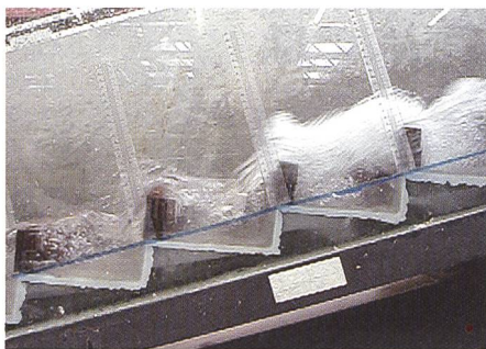
Bild 2. Abflussinstabilitäten (Jump Waves) auf einem Treppengerinne mit Neigung von \theta = 13.6^\circ und einer Stufenneigung von \alpha = -5.0^\circ , einer Schwellenhöhe von w = 60 mm bei einem Abfluss von q = 0.018 m 2 /s (LCH Versuch; Foto Ch. Knellwolf).
