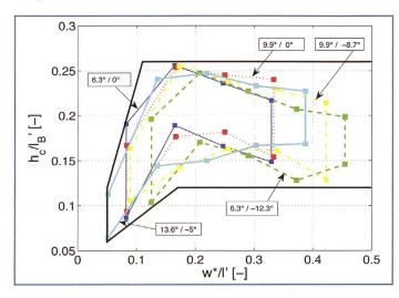
Bild 8. Dimensionslose Darstellung des Grenzbereichs von Jump Waves für rückwärts geneigte sowie horizontale Stufen.
