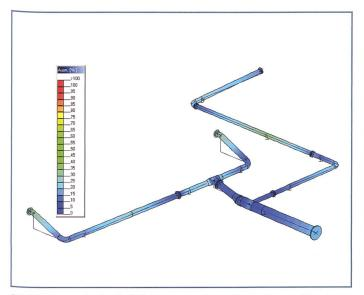
Bild 9. Dynamische Rohrleitungsanalyse, Touss Power Plant.
