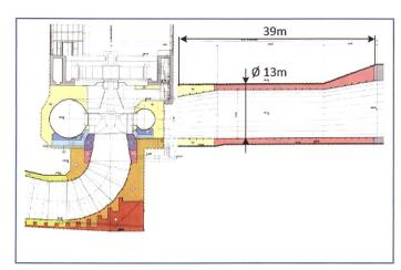
Bild 4. Schema Druckrohrleitung Picote II, Portugal.
