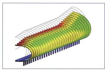
Bild 5. Statik Druckrohrleitung Picote II, Portugal.
