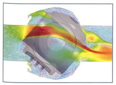
Bild 1. Strömungssimulation im Kugelschieber (BA S.Schindler).
