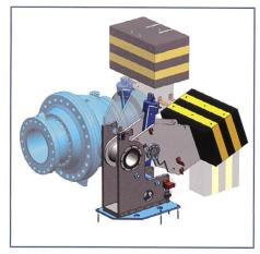
Bild 2. Kugelschieber umgebaut mit Schliessgewichtsantrieb.
