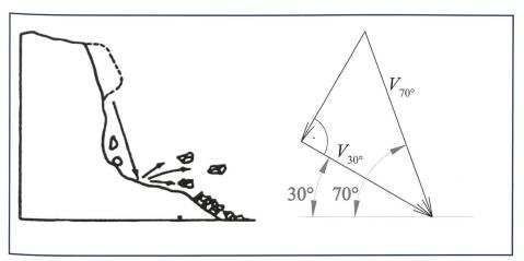
Bild 4. Umrechnung der Rutschgeschwindigkeit bei verändertem Eintauchwinkel (hier  $\alpha = 30^{\circ}$ ) (Heller at al. 2008).
