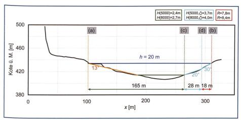
Bild 7. Schnittprofil und Berechnungsschema für den Kalibrierfall K\_2.
