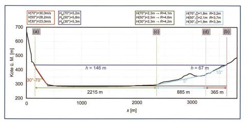
Bild 5. Schnittprofil und Berechnungsschema für den Kalibrierfall K\_1.
