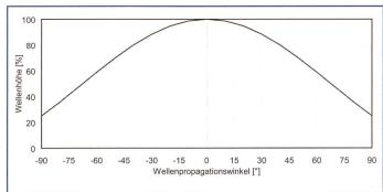
Bild 9. Einfluss des Wellenpropagationswinkels auf die Impulswellenhöhe.
