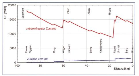
Bild 1. Längenprofil der durchschnittlich transportierten Geschiebefracht (GF) der Aare zwischen der Emme und dem Rhein im unbeeinflussten Zustand sowie um 1995 (vor Neubau KW Ruppoldingen).
