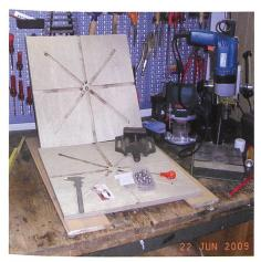
Bild 5.1. Beide Seitenwände des unterläufigen Wasserrads.
