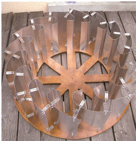
Bild 6.2. Oberläufiges Wasserrad mit nur einer Seitenwand und ohne inneres Blech.
