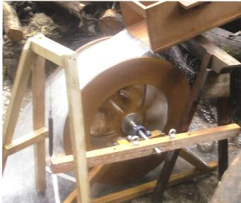
Bild 4.3. Die Prony-Bremse im Einsatz.
