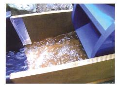
Bild 8.4. Bei grosser Belastung staut sich das Wasser im Kanal.
