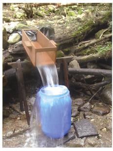
Bild 8.10. Messung der Wassermenge mithilfe eines 60 I-Fasses und einer Stoppuhr.
