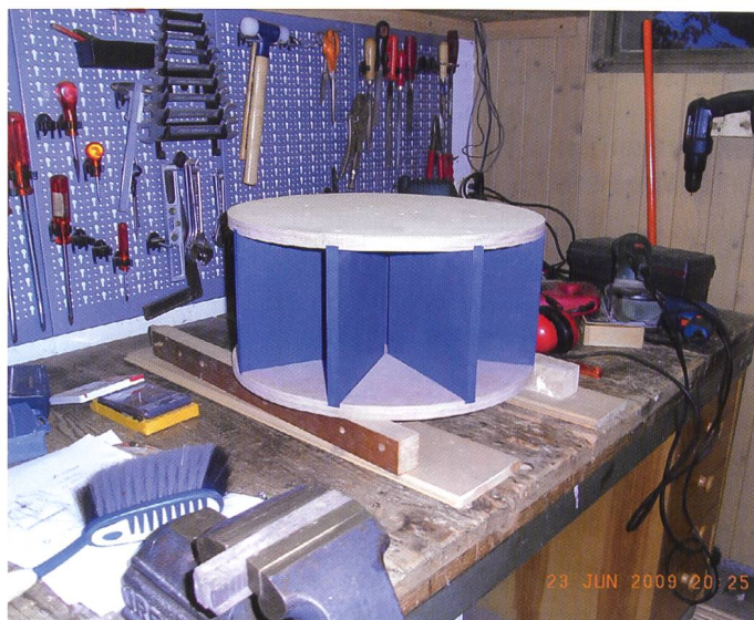
Bild 8.2. Das unterläufige Rad noch in der Werkstatt.
