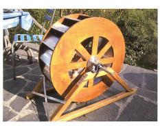
Bild 8.6. Oberläufiges Wasserrad vor dem Betrieb...
