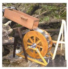
Bild 6.1. Das oberläufige Wasserrad fertig montiert im Bach.
