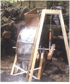
Bild 8.14. Das Rad mit 3 N/m Belastung und einer Zuflussmenge von 2 l/s.
