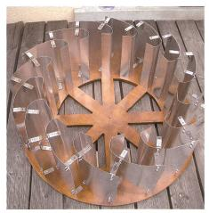
Bild 6.2. Oberläufiges Wasserrad mit nur einer Seitenwand und ohne inneres Blech.
