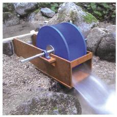
Bild 5.2. Unterläufiges Wasserrad in Betrieb
