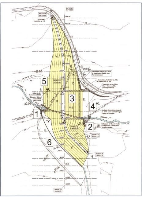
Bild 3. Situation des Rückhaltedammes, (1) Einlauf Durchlassbauwerk, (2) Auslauf Durchlassbauwerk, (3) Hochwasserentlastung, (4) Tosbecken, (5) Notentlastung, (6) Böschungsabtrag Seitentälchen.
