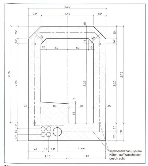
Bild 6. Querschnitt des Durchlasses.
