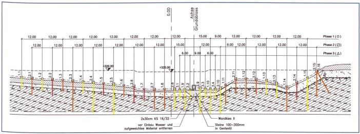
Bild 15. Injektionsgutaufnahmen der Untergrundabdichtung (gelb: < 500 kg/m<sup>1</sup>; orange: 500÷800 kg/m<sup>1</sup>; rot:> 800 kg/m<sup>1</sup>).
