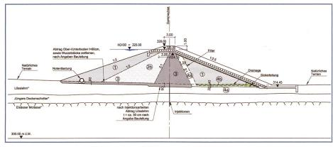
Bild 4. Dammquerschnitt durch Hochwasserentlastung.
