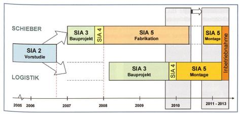
Bild 4. Phasenorientiertes Vorgehen nach Norm SIA 112.
