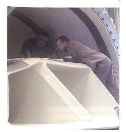
Bild 8. Die Schieber für die Grundablässe sind aktuell in Fabrikation. Die Abnahme ist für Herbst 2010 geplant.
