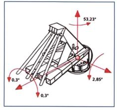
Bild 23. Bewegungsmöglichkeiten des Kugelgelenkes.
