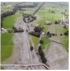
Bild 6. Schwemmkegel Dürrenbach. Aufgefüllte Bachschale mit Übersarungen und Geschiebesammler (Hintergrund). (Flugbild Kapo ZH).
