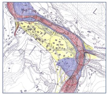
Bild 3. Ausschnitt aus der Gefahrenkarte «nach Massnahmen». Heubach wird nach Ausführung der Massnahmen bei der Brücke erst bei HQ<sub>300</sub> mit geringer Gefährdung betroffen (Szenario: Überströmen der Brücke mit offenem Dammbalkenverschluss).
