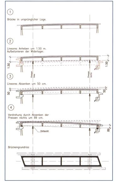
Bild 4. Phasen der Brückenanhebung/-absenkung. In Phase 4 wird um die linken Pressen verdreht.
