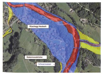
Bild 1. Ausschnitt aus der Gefahrenkarte Rüschegg. Das Schwarzwasser umfliesst von rechts unten nach links oben im Bild den Ortsteil «Heubach». Beim Ausbruch des Schwarzwassers an der Stalenmoosbrücke wird fast der ganze Dorfteil «Rüschegg Heubach» überschwemmt.
