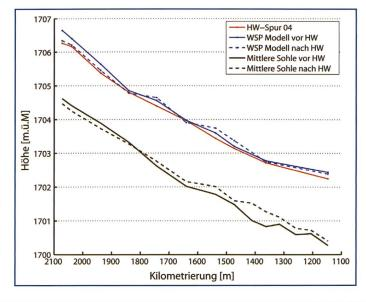
Bild 3. Abschnitt alternierende Bänke: Lokal herausgelesene Wasserspiegel (WSP) im Längsprofil für das Modell vor und nach HQ<sub>2004</sub> im Vergleich zur Hochwasserspur des HQ<sub>2004</sub>.
