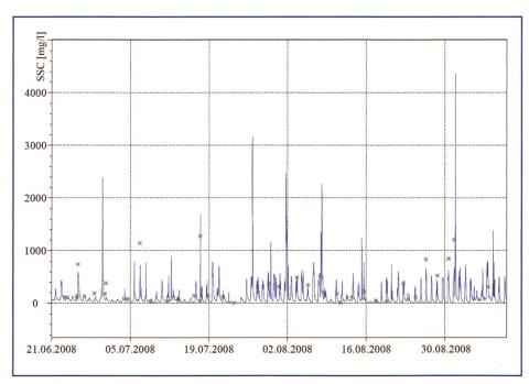
Bild 1. Verlauf der Schwebstoffkonzentration im Triebwasser des KW Dorferbach im Sommer 2008, (-) Daten der Trübungssonde nach Kalibrierung mit (\( \)) Einzelproben.
