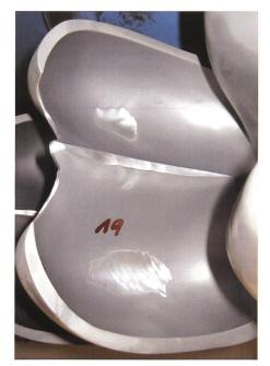
Bild 7. Laufrad 2 (mit Wolframkarbid-Beschichtung) nach 80 Volllasttagen während der Schwebstoffsaison.
