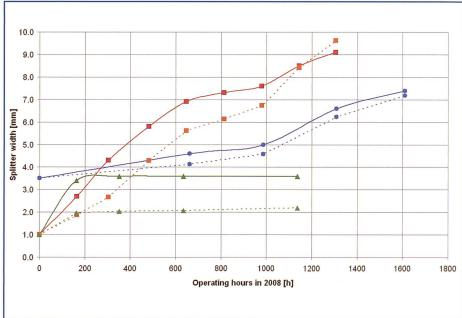
Bild 8. Entwicklung der Mittelschneidenbreite in Abhängigkeit der Betriebsstunden am KW Dorferbach von Mai bis Oktober 2008, (–) gemessene Daten und (…) berechnet nach Gl. (3), bei Laufrad ( $\blacksquare$ ) 1, ( $\bullet$ ) 2 und ( $\blacktriangle$ ) 3. Laufräder 2 und 3 sind beschichtet.
