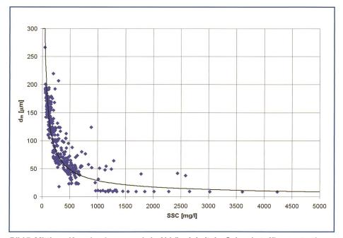
Bild 5. Mittlerer Korndurchmesser d<sub>m</sub> in Abhängigkeit der Schwebstoffkonzentration SSC aus Laserdiffraktometer-Daten, (–) Näherung durch Gl. (1).
