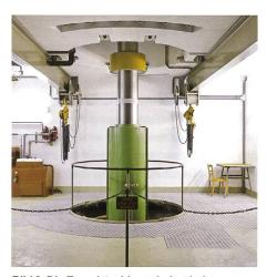
Bild 3. Die Francisturbine arbeitet bei umgedrehter Drehrichtung auch als Pumpe. Dabei werden keine separaten Turbinen und Pumpen eingesetzt.
