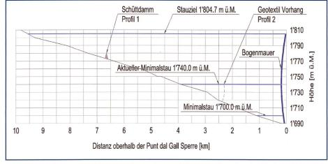
Bild 6. Lage der vorgeschlagenen technischen Lösungen im Stausee Livigno: Schüttdamm und Geotextilvorhang als Hindernis gegen Trübeströme.
