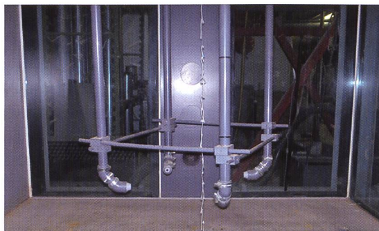
Bild 3. Versuchsanlage für kreisförmig angeordnete Düsen zur Erzeugung einer Aufwärtsströmung. Links: Detail einer Düse. Rechts: Düsenanordnung vor der Fassung Schemaskizze der mit dem Wasser der Beileitungen gespiesenen Wasserstrahlen in der Frontwand im Hintergrund (Jenzer et al. 2009).
