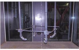
Bild 3. Versuchsanlage für kreisförmig angeordnete Düsen zur Erzeugung einer Aufwärtsströmung. Links: Detail einer Düse. Rechts: Düsenanordnung vor der Fassung Schemaskizze der mit dem Wasser der Beileitungen gespiesenen Wasserstrahlen in der Frontwand im Hintergrund (Jenzer et al. 2009).
