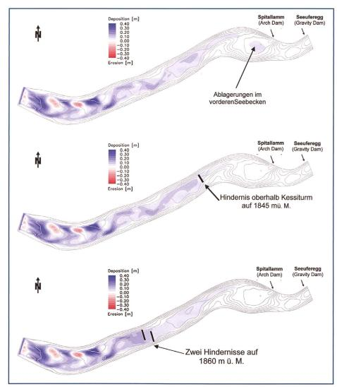
Bild 5. Ablagerungen und Erosionen eines im Grimselstausee simulierten Trübestroms während dem Hochwasser vom Oktober 2000 (Abflussspitze 40 m³/s, angenommene Sedimentkonzentration 15 g/l). Oben: ohne Massnahmen, Mitte: Hindernis oberhalb Kessiturm auf 1845 m ü. M (Variante 1), Unten: Zwei Hindernisse 1860 m ü. M (Variante 2).
