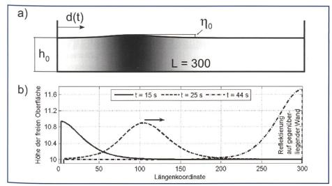
Bild 3a. Geometrie, die Zonen mit hoher absoluter Geschwindigkeit sind in Grau dargestellt, b) freie Oberfläche zu verschiedenen Zeitpunkten: Beginn, im Anfangsstadium der Wellenbewegung, bei der Reflektion.
