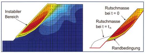
Bild 1. Bestimmung der instabilen Masse (links), Bereich, der für Rutschanalyse berücksichtigt wird (rechts). Verschiebungsamplitude: rot = maximal, blau = 0.
