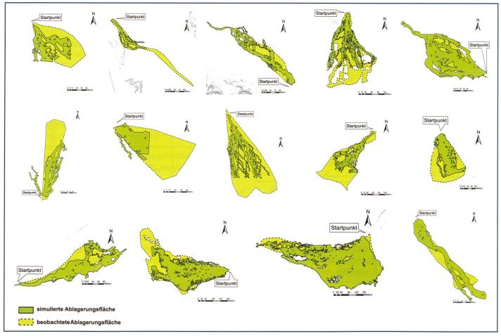
Bild 8. TopRunDF-Simulation für 14 Murgangereignisse aus der Schweiz unter Verwendung von k<sub>Bprog</sub> nach Gl. (8).
