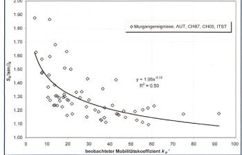
Bild 11. Zusammenhang zwischen dem Verhältnis beobachtetes Reibungsgefälle zu Kegelgefälle ( $S_R$ '/sin  $\theta_K$ ) und dem beobachteten Mobilitätskoeffizienten  $k_B$ '.
