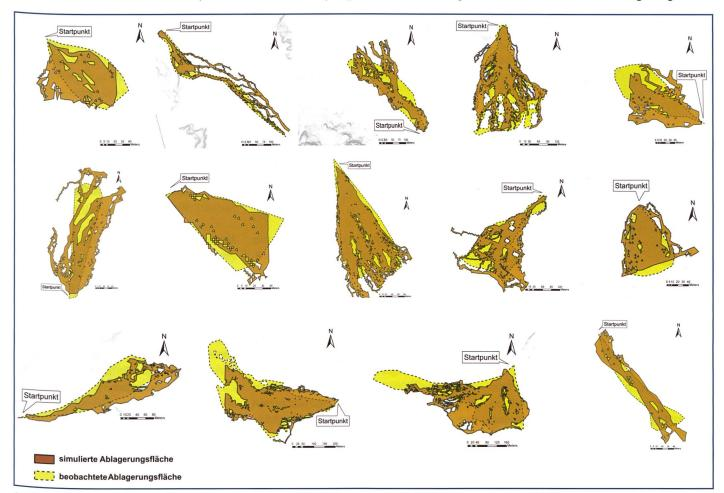
Bild 7. TopRunDF-Simulation für 14 Murgangereignisse aus der Schweiz unter Verwendung der effektiv beobachteten Ablagerungsfläche (d.h. mit k<sub>B</sub>' nach Gl. 7).
