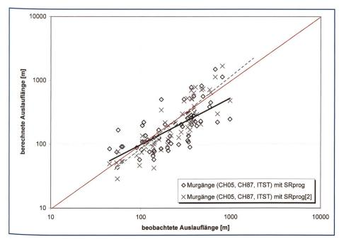
Bild 12. Vergleich der berechneten Auslauflängen (Gl. 11a-c) bei Anwendung von S<sub>Rprog</sub> Gl. (17) (schwarze Trendlinie für eine Regression mit Potenzfunktion) bzw. S<sub>Rprog[2]</sub> nach Gl. (18) (strichlierte hellgraue Trendlinie für eine Regression mit Potenzfunktion) mit den beobachteten Auslauflängen. Die rote Linie entspricht der 1:1-Beziehung zwischen berechneter und beobachteter Auslauflänge.
