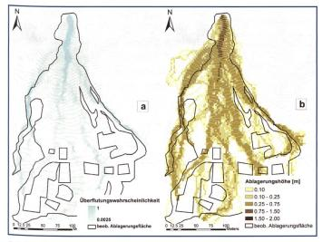
Bild 6. TopRunDF-Simulation für den Glattbach: a) Simulierte Überflutungswahrscheinlichkeiten; b) Simulierte Ablagerungshöhe. Beide Simulationen wurden mit  $k_{\rm B}$ ', d.h. mit der effektiv beobachteten Ablagerungsfläche durchgeführt.
