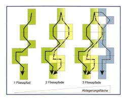
Bild 5. Modellierung der potenziellen Ablagerungsfläche aufgrund multipler Fliesspfade (nach Scheidl & Rickenmann, 2009).
