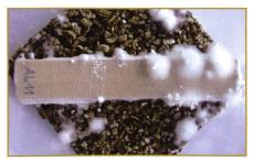
Bild 4. Mit Pilzen infizierte Fichtenholzprobe an der Empa.
