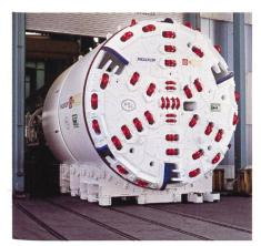
Bild 2. Erddruckschild S-391 nach Abnahme im Werk.
